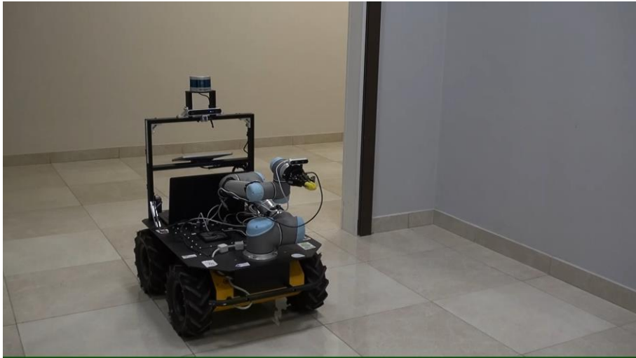
Лабораторный мобильный робот Husky с манипулятором UR5
